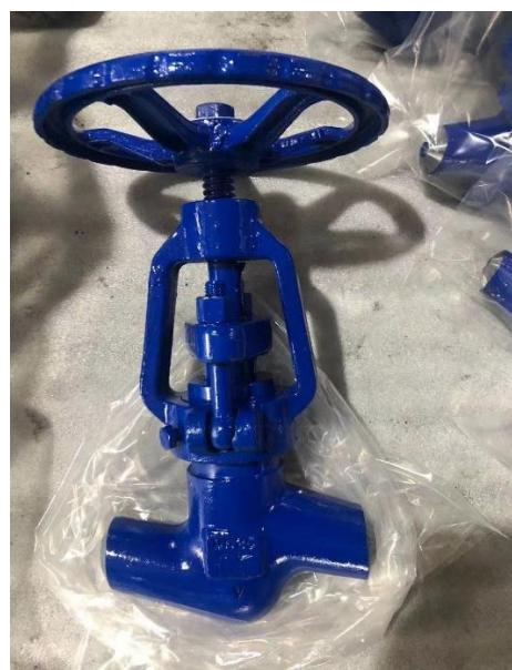
Положительным качеством клапана запорного (вентиля) является сравнительно небольшой ход тарелки, необходимый для полного открытия вентиля. Поэтому вентиль имеет значительно меньшую габаритную высоту, чем задвижка того же диаметра прохода.
