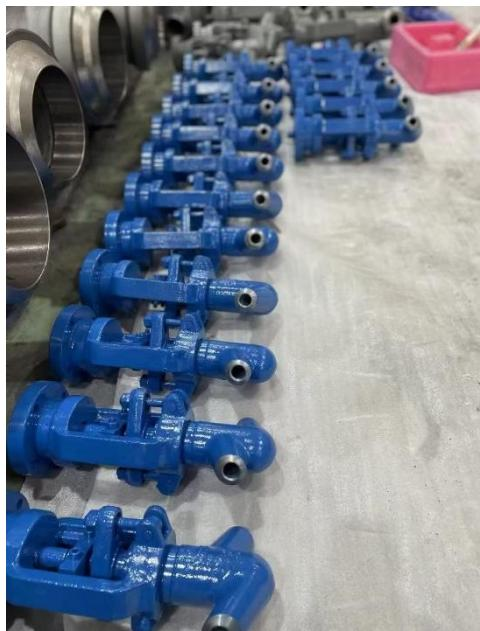
Рабочее положение клапанов запорных на трубопроводе любое. Направление подачи рабочей среды под золотник (по направлению стрелки на корпусе). При установке на трубопроводе необходимо предусмотреть дополнительную опору под редуктор или привод.
